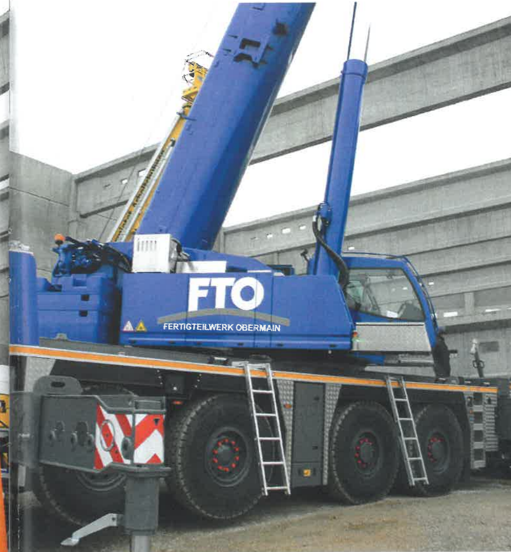
Der Tadano ATF 220G-5 beim Hub einer der 35 t schweren Spann- betonträger.
